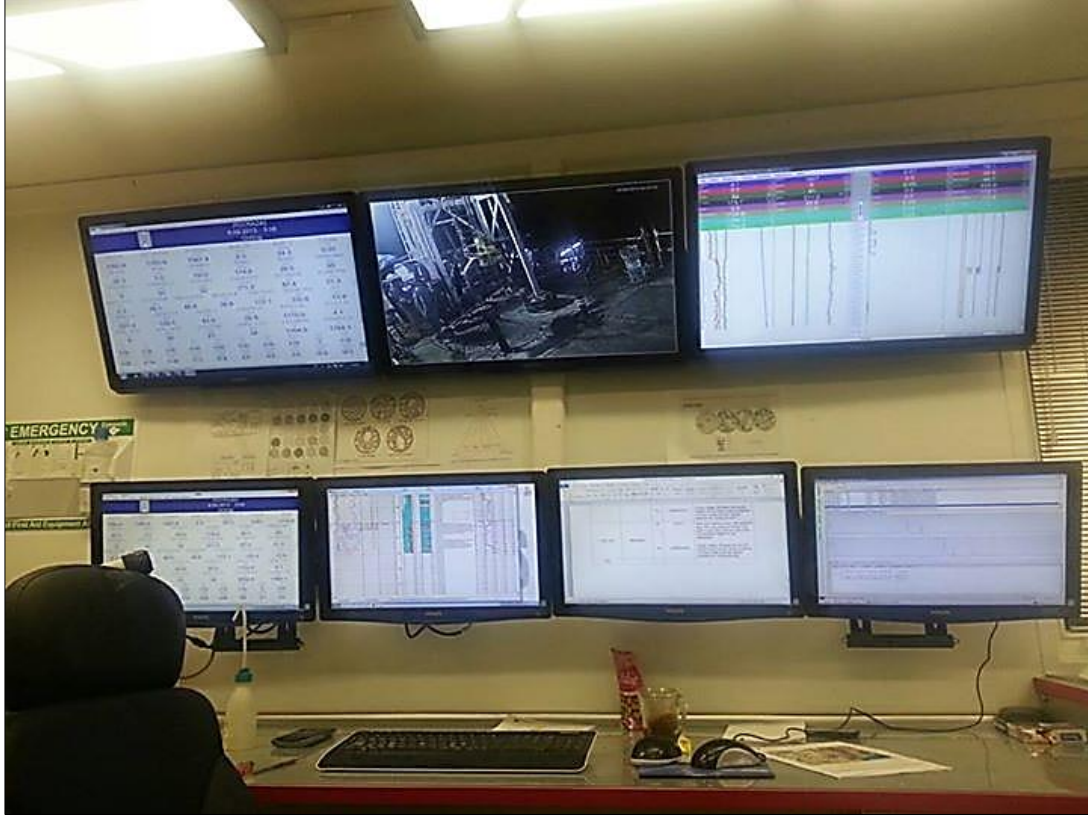
Şekil 5.11. Mudlogging ünitesi içerisinde bir görünüm. Sondaja dair tüm kritik bilgiler bu üniteye toplanır ve birçok ekran ile anlık olarak takibi yapılır
